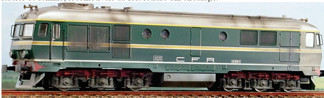
Fig. 18.1. Imaginea locomotivei diesel electrice clasa 66 seria DD cu motor termic de tracțiune Alco Auburn
