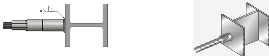
Figura 5 – Sisteme de cuple de pentru fixarea pe elemente metalice – profile din oțel
