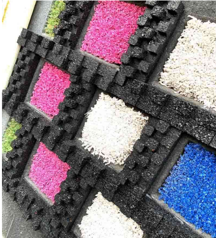
Fig. 1. Panou fonoizolator și fonoabsorbant cu gazon sintetic de diferite culori
