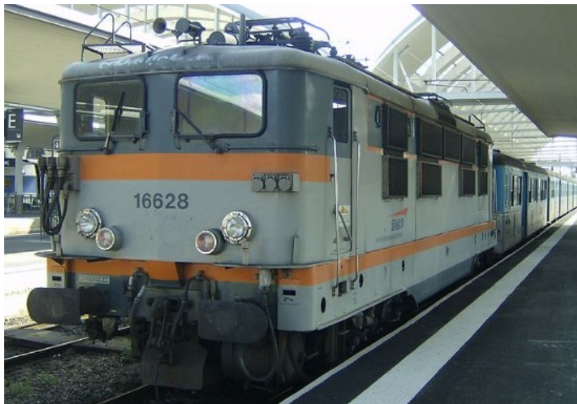
Fig. 1. Locomotiva electrică seria BB 16500
