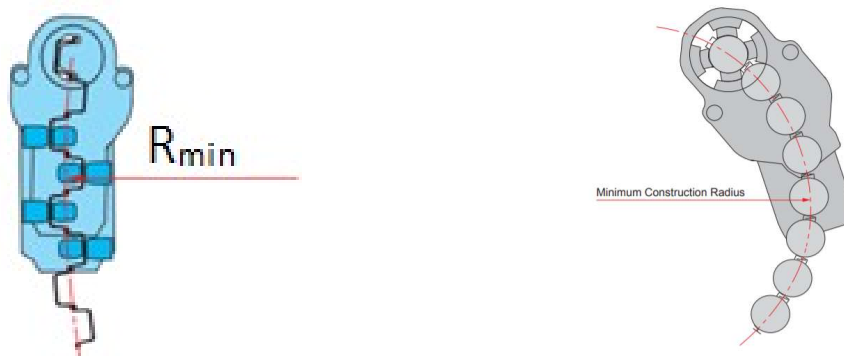
a - echipament pentru relizarea peretilor de palplanse, in curba
